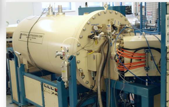
Krok 4: Pomiar AMS składu izotopowego of Δ 14 C
